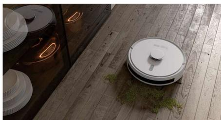
Tre modalità: SMART (pulizia totale degli ambienti), AREA (pulizia di una o più stanze) e SPOT (pulizia localizzata e intensiva di un'area di 1,5 m<sup>2</sup>).
