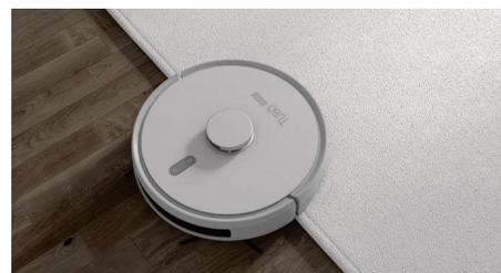
Quando rileva un tappeto attiva automaticamente la potenza di aspirazione massima per garantire una pulizia estremamente accurata.
