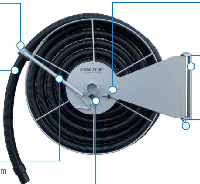
Die ausgeklügelte Schaltmechanik mit Mikroschalter und Absperrschieber lässt den Einsatz von unendlich vielen Schlauchaufrollern an einem Zentralstaubsauger zu. Ebenso den Einsatz von zusätzlichen herkömmlichen Saugschläuchen im System. Nach Beendigung des Saugvorganges ist der Vakuum-Anschluss verschlossen.
